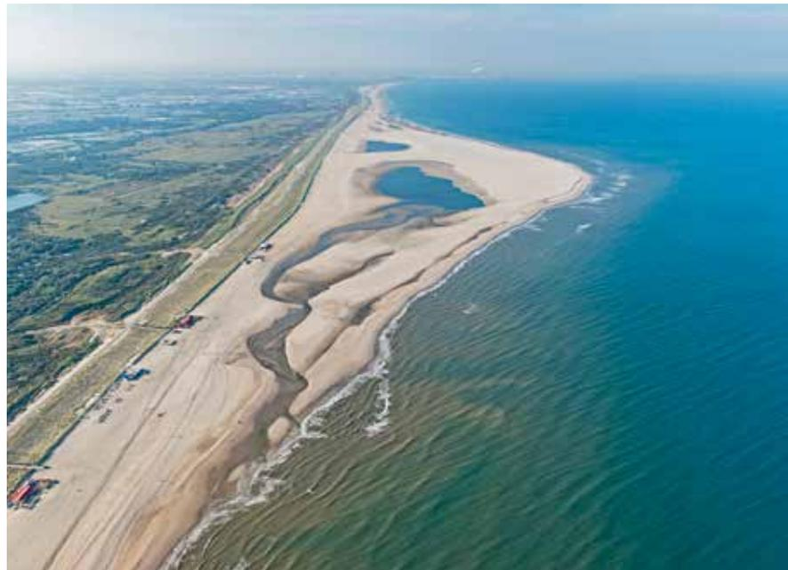
Abbildung 18: Der Zandmotor im Jahr 2013. Nach und nach verteilt sich der Sand an der Küste.
